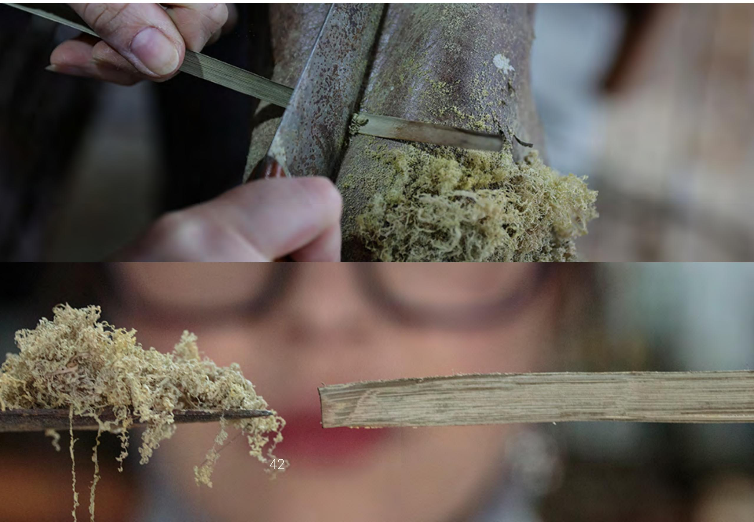
eficiente. A intensidade da raspagem varia conforme o tipo de produto desejado e a flexibilidade necessária para a peça.
